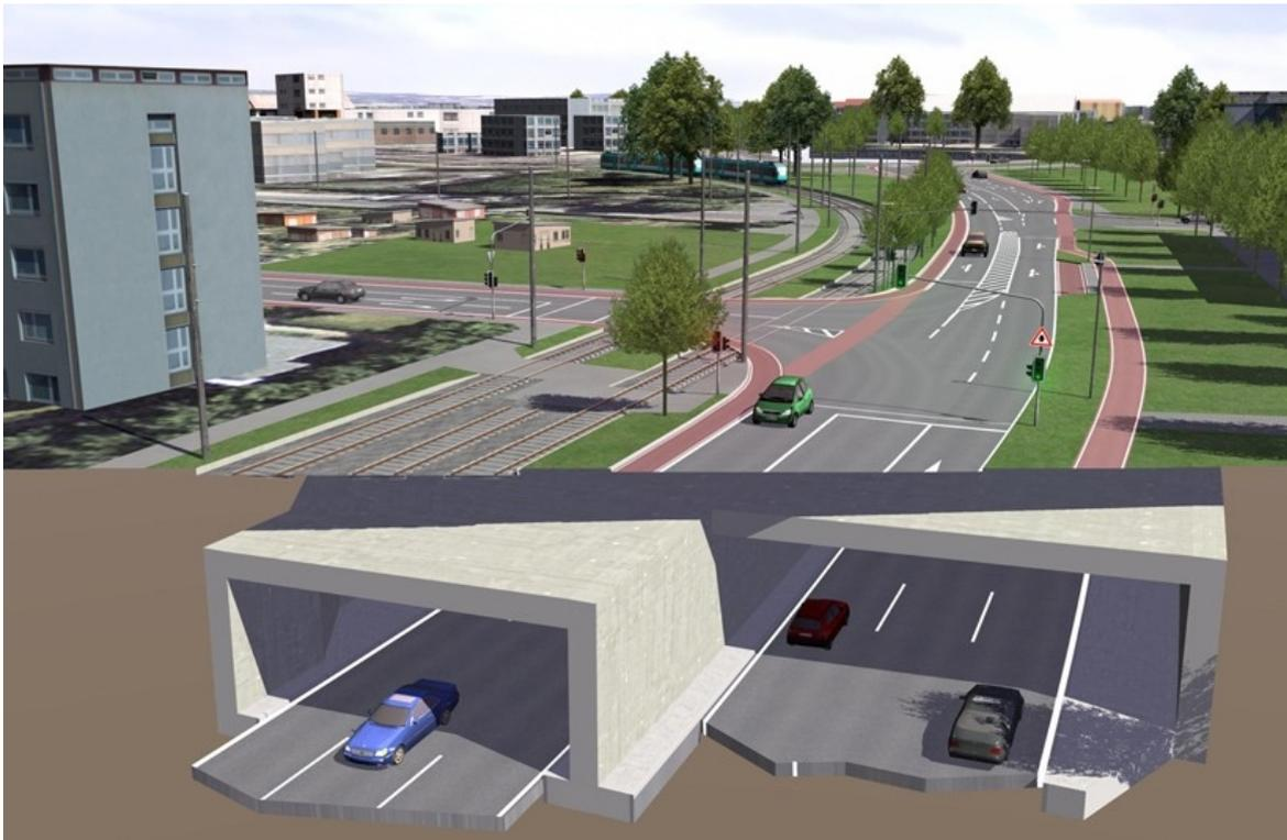
Visualisierung eines Querschnittes durch den Riederwaldtunnel einschließlich der darüber liegenden Straßen sowie der Bebauung.
